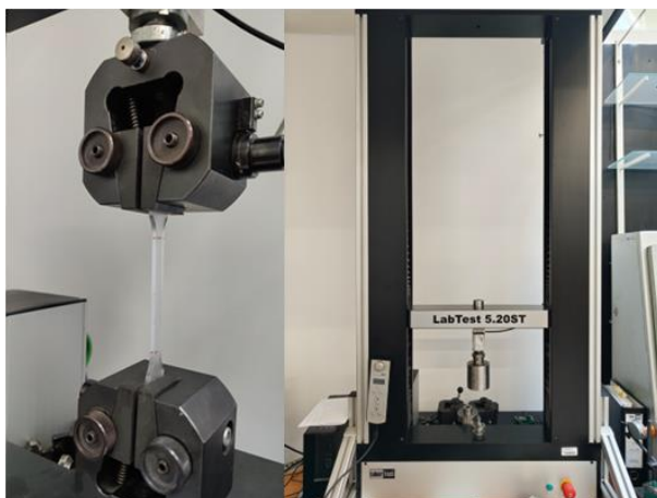
Obr. 4 – Zariadenie používané pre ťahové skúšky
