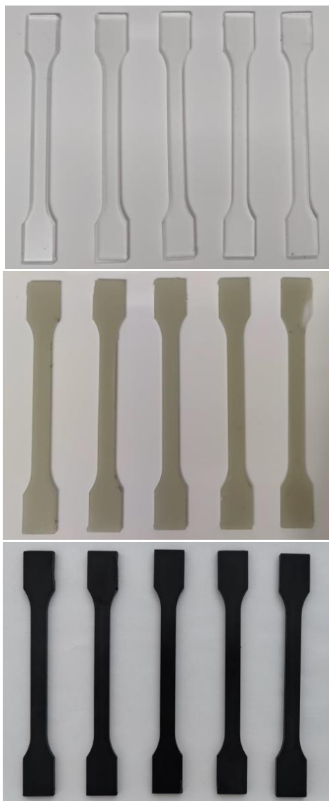
Obr. 3 – Vzorky vlastnej výroby PRC 1810, PRC 1810 GF30, PRC 1810 CF20
