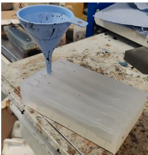
Obr. 2 – Silikónová forma pre výrobu vzoriek
