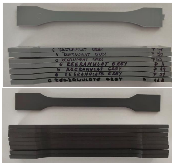
Obr. 1 – Polyamid 6 (šedý) a polyamid 6 plnený skleneným vláknom (čierny)
