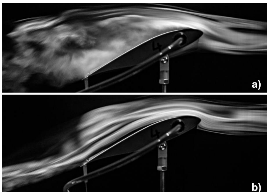
Obr. 1 – Porovnanie prúdenia na krídle s uhlom nábehu 21,3^\circ ; a) bez aktívneho HLFC ; b) s aktívnym HLFC [17]
