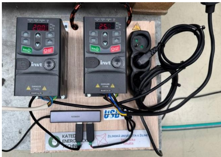
Obr. 2 : Modulárna jednotka s frekvenčnými meničmi
