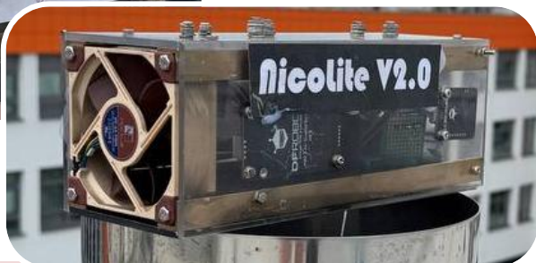
Obr. 3 : IoT bezdrôtové monitorovacie zariadenie kvality spaľovania
