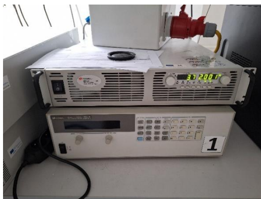
Obr. 7 Zdroj elektrického napájania pri galvanizácii
