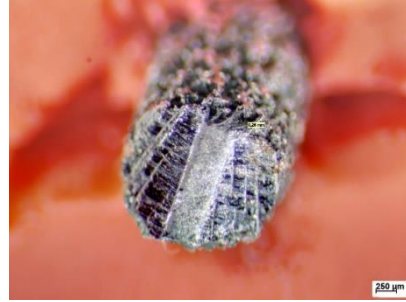
Obr. 8 Mikroskopický pohľad drôtu po nanosení Ni pomocou stereomikroskopu LEICA M205
