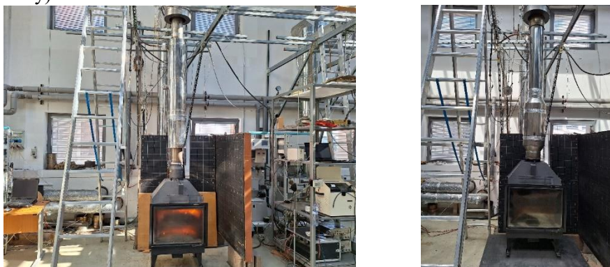
Obr. 2 – zapojenie krbových kachlí pre diskontinuálne spaľovanie tuhého paliva
