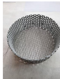
Obr. 5 Pripravené 3 úrovne sit z drôtu z Kanthalového materiálu
