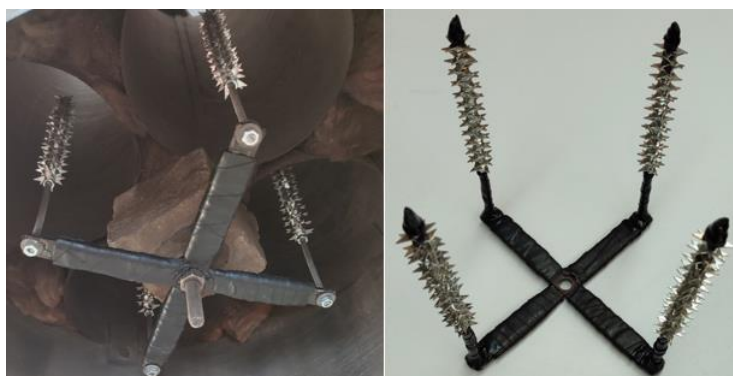
Obr. 4 Elektrostatický odľučovač TZL so 4 nabíjacími elektródami – typ zápornej elektródy – hviezdicový tvar
