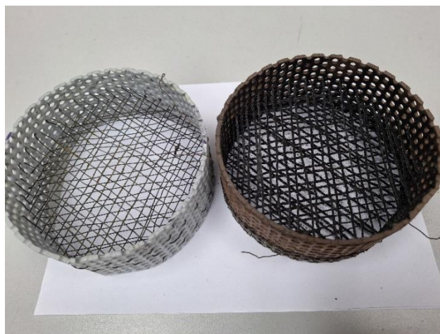
Obr. 32 Porovnanie sit – vľavo nepoužitý, vpravo po viacnásobnom meraní
