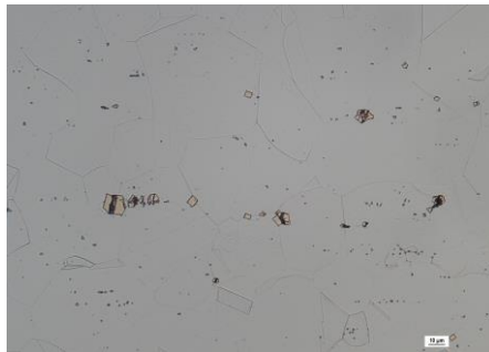
Obr. 1 Mikroštruktúra AISI 316Ti v priečnom reze (leptané Kallingovým činidlom č. 2, zväčšenie 400x)
