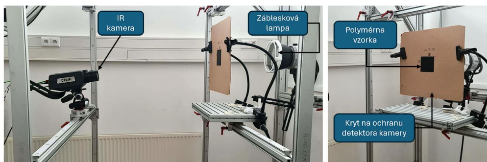
Obr. 4 Usporiadanie meracej zostavy pre meranie tepelnej difuzivity
