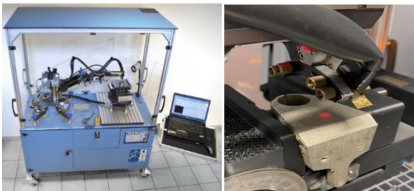
Obr. 5.24 Zariadenie Proto iXRD určené na meranie zvyškových napätí (vľavo), meranie zvyškových napätí na aditívne vyrobenej vzorke (vpravo)
