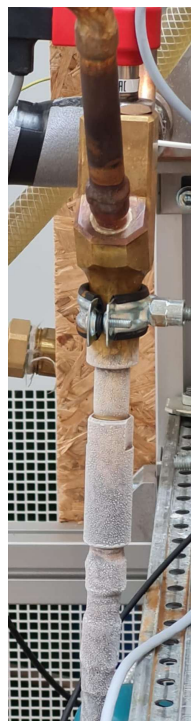
Obr. 3.4 Namŕzanie ejektora počas prevádzky
