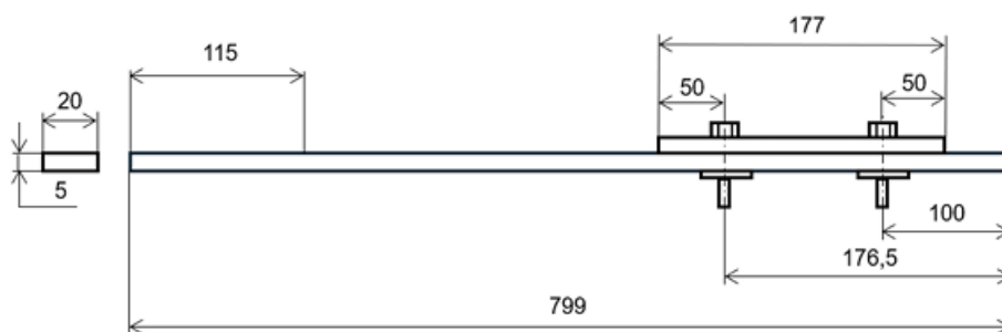
Obr. 2 Rozmery meraných vzoriek a konfigurácia pri experimente v milimetroch
