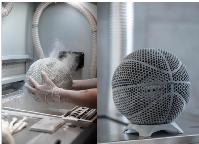
Obrázok 3.2 Materiál PA12 pred a po odstránení z vyrobeného dielu
