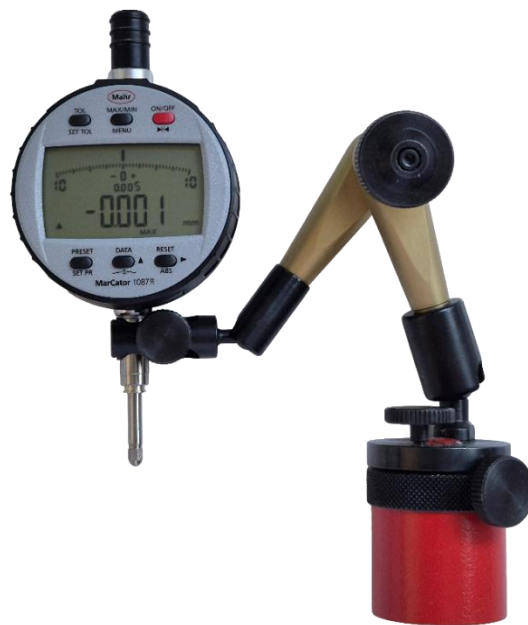
Obrázok 6.1 Odchýlkomer od výrobcu Mahr osadený v magnetickom držiaku
